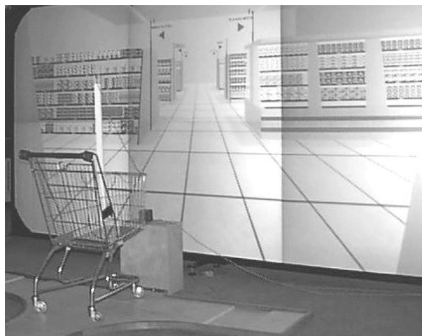
Figure 8 – Chariot instrumenté pour le déplacement « naturel » dans le magasin virtuel (doc. EMP)
