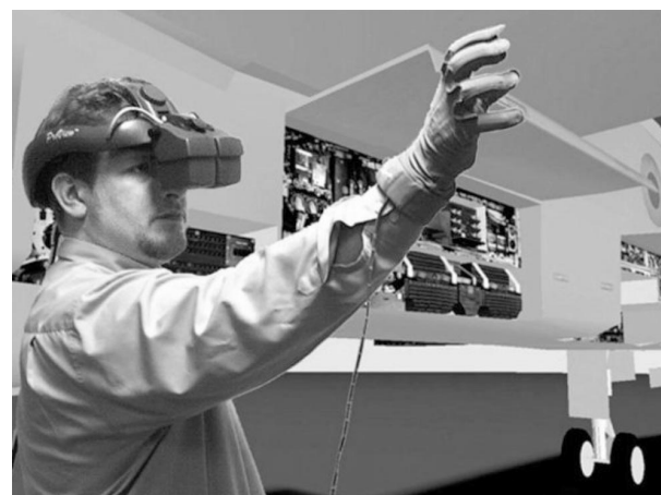
Figure 5 – Maintenance par un opérateur équipé d'un visiocasque et d'un gant numérique (doc. Sim Team)
