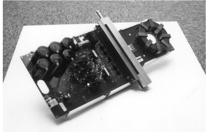
Figure 4 – Module d'amplification et transformateur de sortie (Émetteur Thomcast S7 HP)
