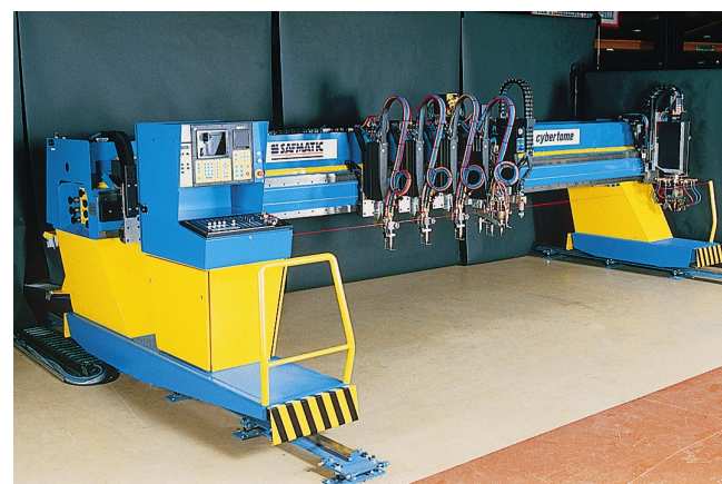
Figure 20 – Très grande machine portique à commande numérique [Doc. SAF]
