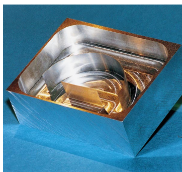
Figure 48 – Finition d'un raidisseur d'épaisseur 0,1 mm et de 25 mm d'élancement
