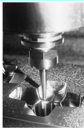
Figure 22 – Finition d'une matrice (doc. CETIM)
