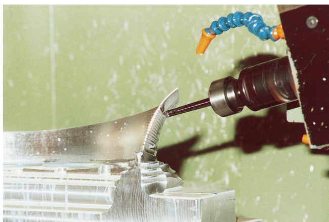
Figure 56 – Usinage avec dépinçage sur machine 5 axes (doc. ENSAM)
