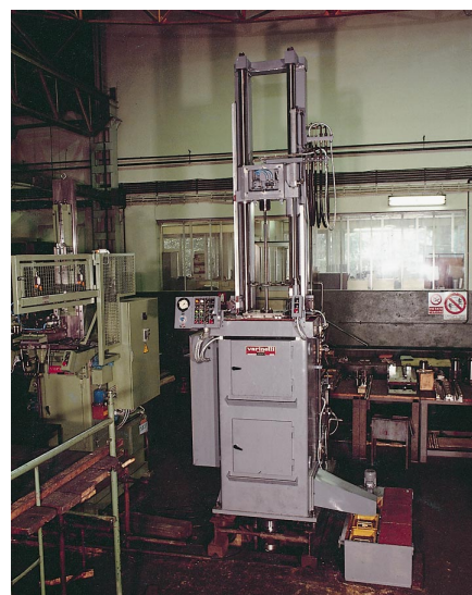
Figure 2 – Brocheuse verticale d'intérieur à traction (Document Varinelli)
