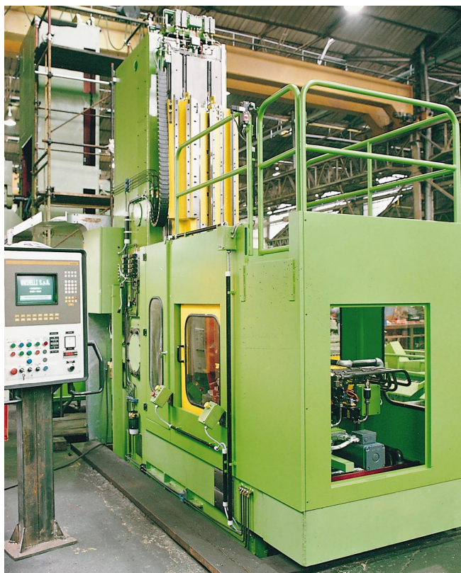
Figure 14 – Cartérisation d'une brocheuse verticale (Document Varinelli)
