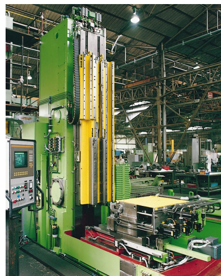
Figure 4 – Brocheuse verticale d'extérieur à table rétractable (Document Varinelli)
