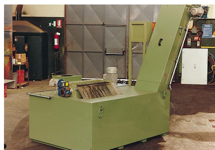
Figure 10 – Bac d'arrosage avec dispositif de séparation (Document Varinelli)
