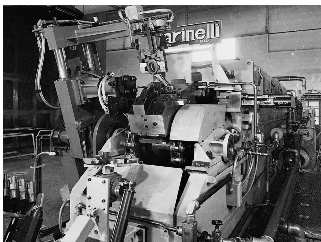
Figure 11 – Bras manipulateur pour alimentation sur brocheuse à chaînes (Document Varinelli)
