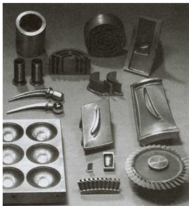
Figure 20 – Exemples de pièces usinées par ECM (doc. AEG-Eltherm)
