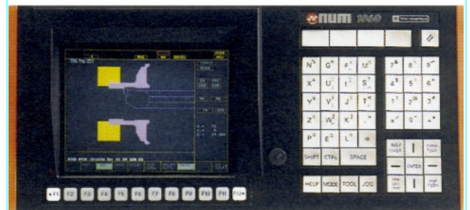
b pupitre opérateur d'une CN 32 bits
