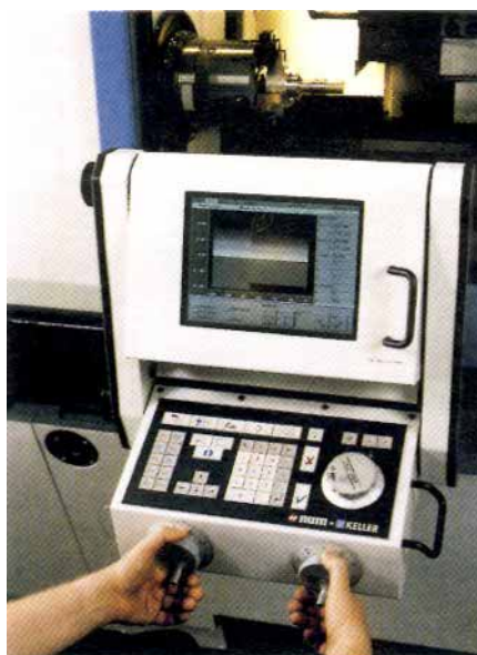
Figure 34 – Commande par apprentissage NUM CNCplus (doc. NUM / Keller)
