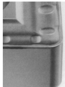
Figure 42 – Rayon de bec sur une plaquette
