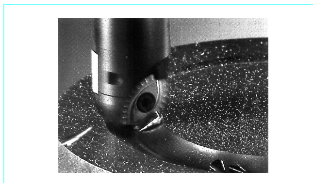
Figure 41 – Fraise à rainurer à bout sphérique travaillant dans plusieurs directions avec des plaquettes à géométrie positive
