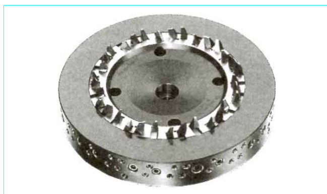
Figure 12 – Fraise Oelinkon à lames réglables axialement ou radialement
